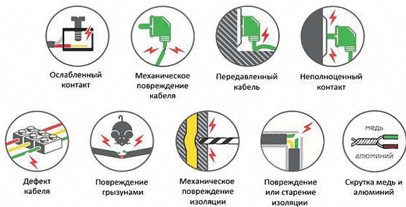
Рисунок 1. Возможные причины искрения в электрических сетях
